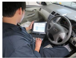
▲外部診断器や各種テストを活用して点検作業中
