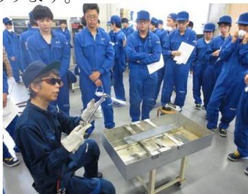
▲切断用の吹管を使用して、厚さ6ミリ鋼板の切断にチャレンジ!
