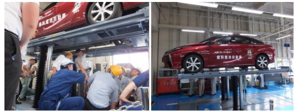
▲燃料電池車(FCV)のトヨタミライをリフトアップ
